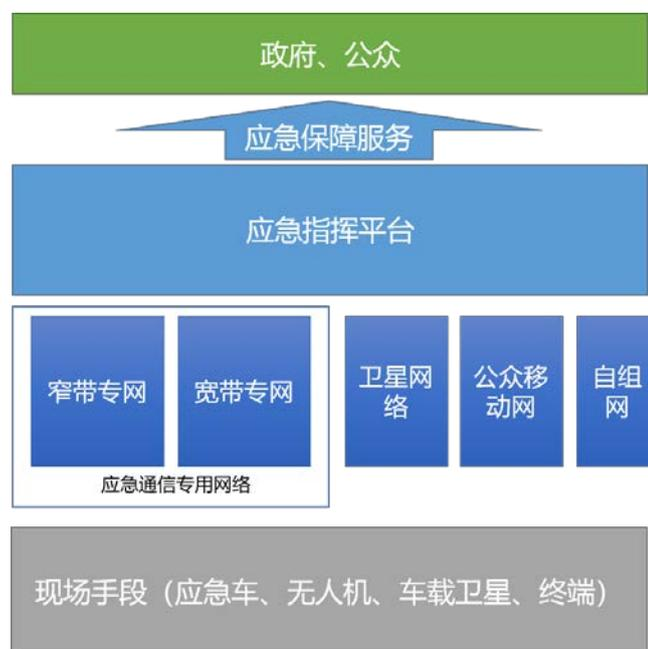
图 1 未来应急通信系统架构
